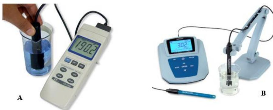
**Figura 2.12.** Condutivímetro portátil (A) e de mesa (B) para análise da condutividade eléctrica.
