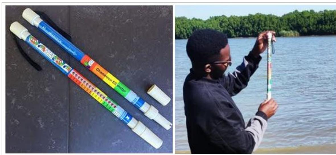
**Figura 2.13.** Leitura da salinidade da água do rio Limpopo com o condutivímetro portátil da VIA.
