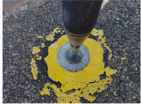
Figura A2: Marcas de nivelamento.
