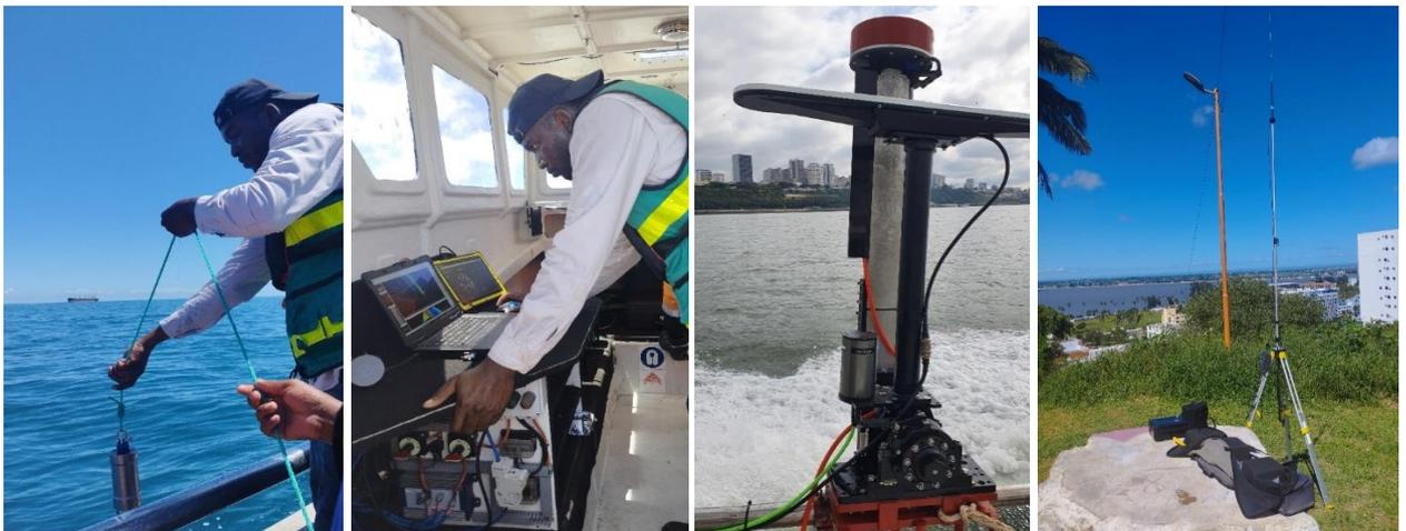
Figura A5: SVP, SIS e Seapath, Transdutor e Suporte e Repetidora.
