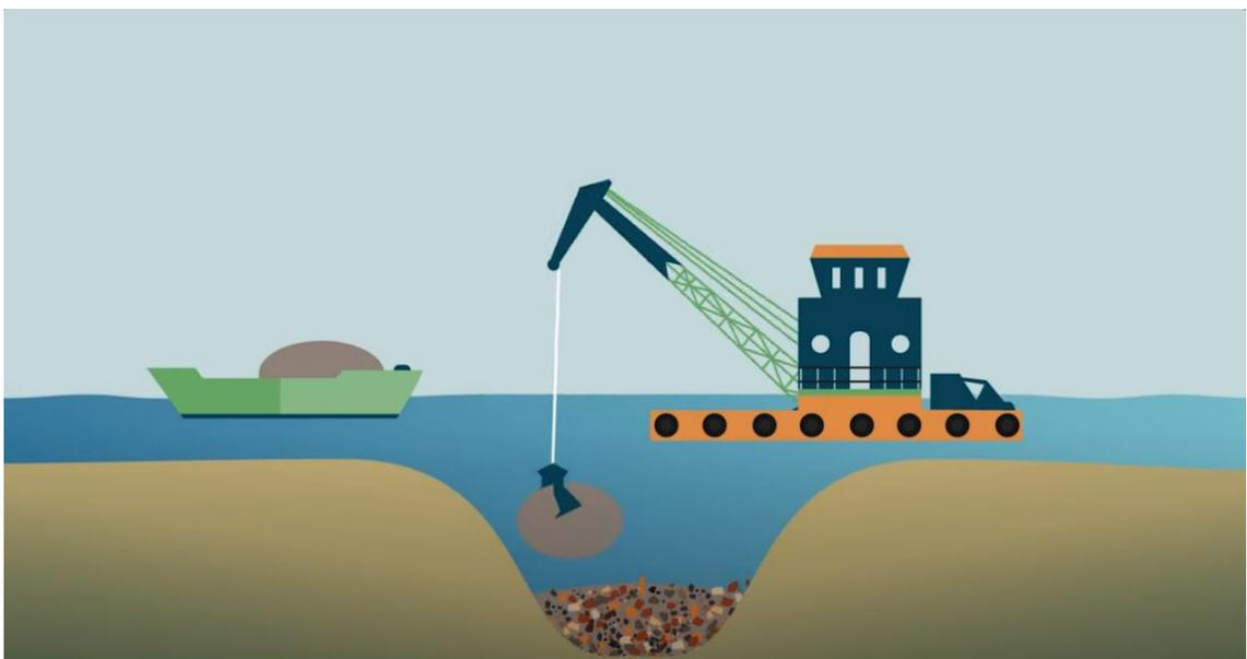
Figura 7: Exemplo de operação de dragagem.
