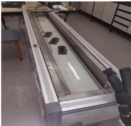
**Figura 27.** Ductilómetro usado para a medição das propriedades de tracção das amostras de asfalto.
