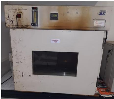
**Figura 26.** Estufa de Película Delgada Rotacional – RTFOT usada para simular o envelhecimento a curto prazo.
