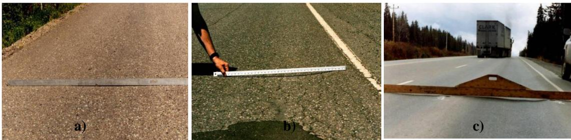
**Figura 14.** Deformação permanente (*rutting*): a) deformação permanente de baixa severidade; b) deformação permanente de média severidade; deformação permanente de alta severidade (WSP Canada Limited, 2020).
