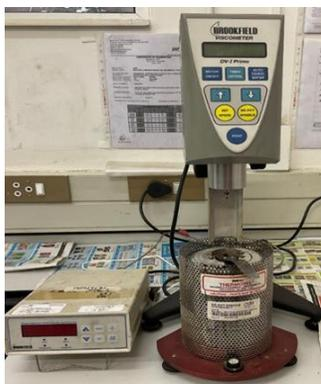
**Figura 25.** Viscosímetro rotacional usado para determinação da viscosidade.
