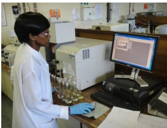
**Figura 16.** Determinação de minerais por espectrofotometria de absorção atómica por chama
