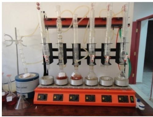
**Figura 15.** Processo de extracção de açúcares
