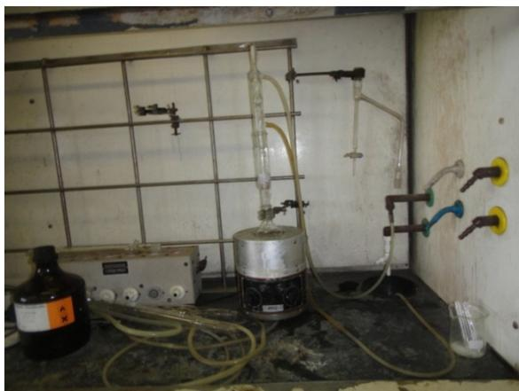
**Figura 13.** Sistema Soxhlet durante extracção de gorduras
