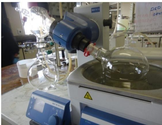
**Figura 14.** Processo de evaporação de solvente no rotavapor
