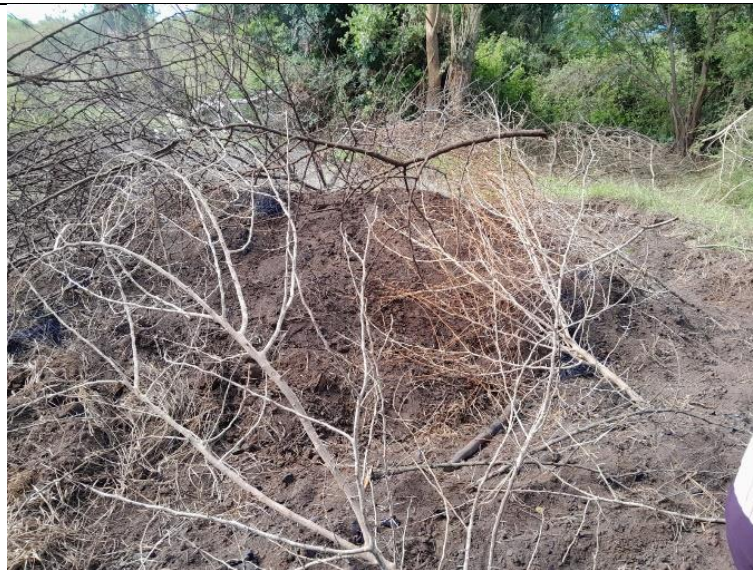
Figura 12: Processo de produção do carvão vegetal: (a) Amontoamento da lenha; (b) Cobertura da lenha com capim; (c) Cobertura do capim com areia (fase inicial); (d) Cobertura do capim com areia (fase mediana); (e) Cobertura do capim com areia (fase final); (f) Introdução de lenha nas fendas laterais do forno para dar início ao processo de combustão e ventilação; (g) Protecção do forno com troncos espinhosos contra a invasão do gado.
