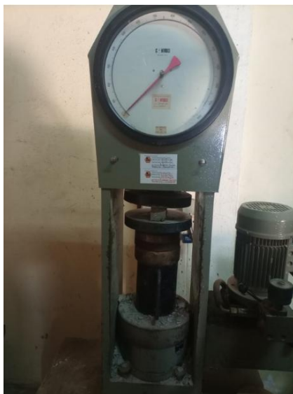
Figura 7: Ensaio de resistência à compressão.
