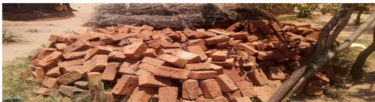
Fig. 11: Bloco burro no processo de secagem; de lado a palha usada para a cobertura (foto tirada pela autora, 07 de Dezembro de 2019).
