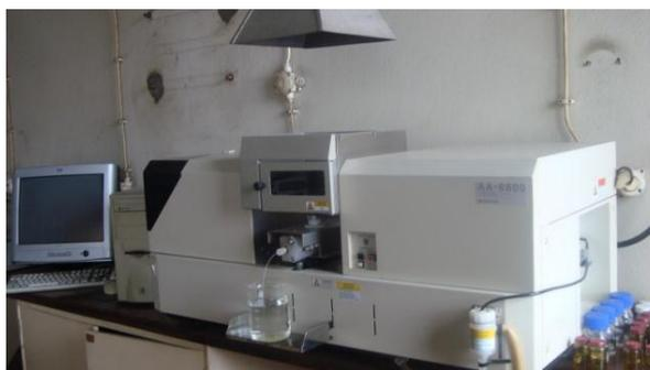
Figura 11: Aparelho de absorção atômica SHIMADZU
