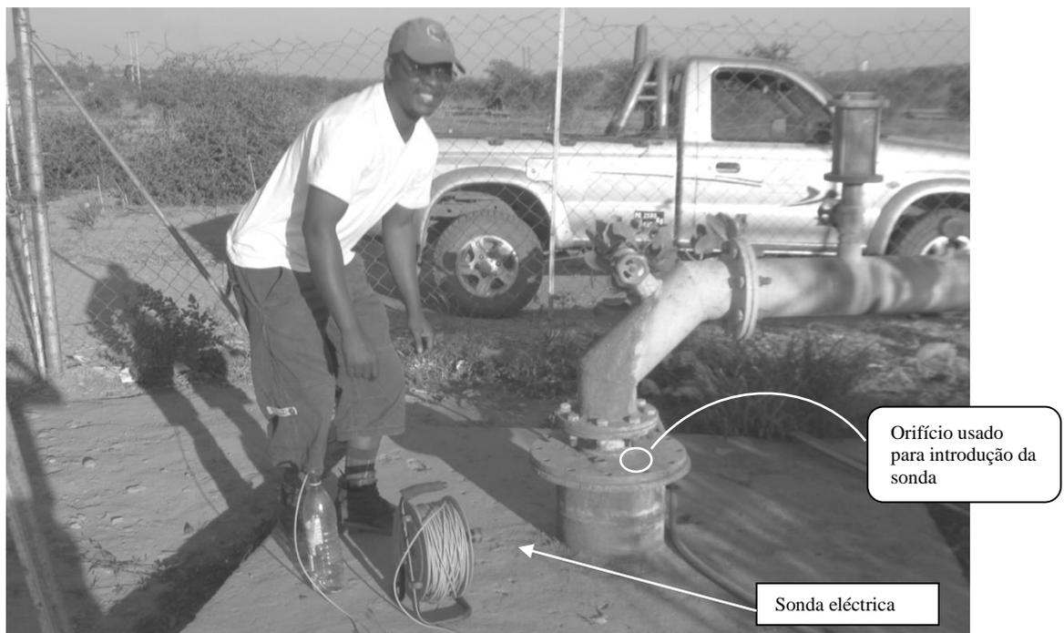
**Figura 5-15: Medição do nível de água num furo, área de Matundo**
