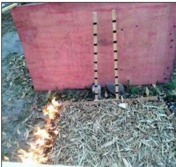
Figura 5: Régua medidoras do comprimento das chamas. Fonte: Oliveira Marcus (2016).
