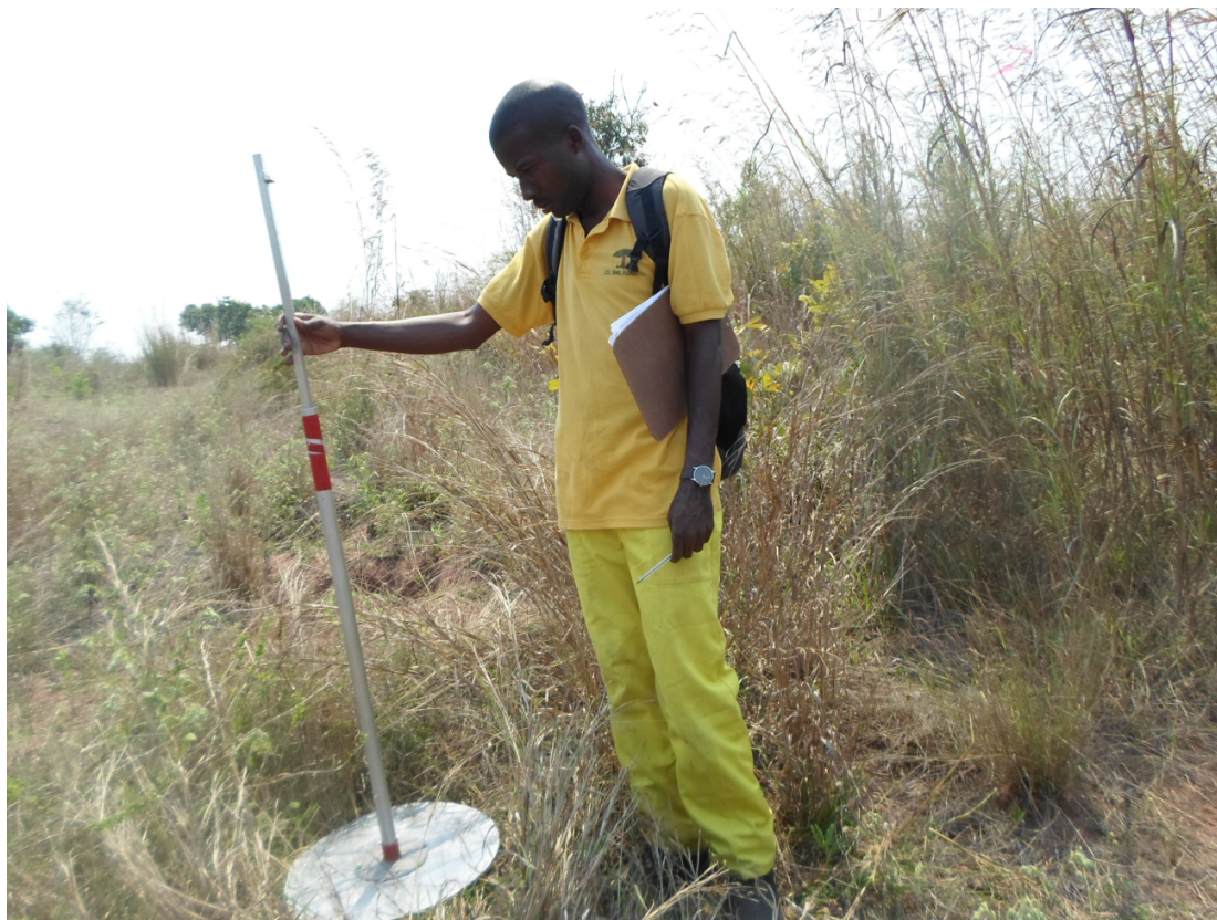
Figura 4 Medição da altura da biomassa
