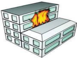
Figura 15: Esquema ilustrativo de uma propagação entre edificações geminadas por condução; irradiação e convecção Fonte: www.safety-smt.com.br
