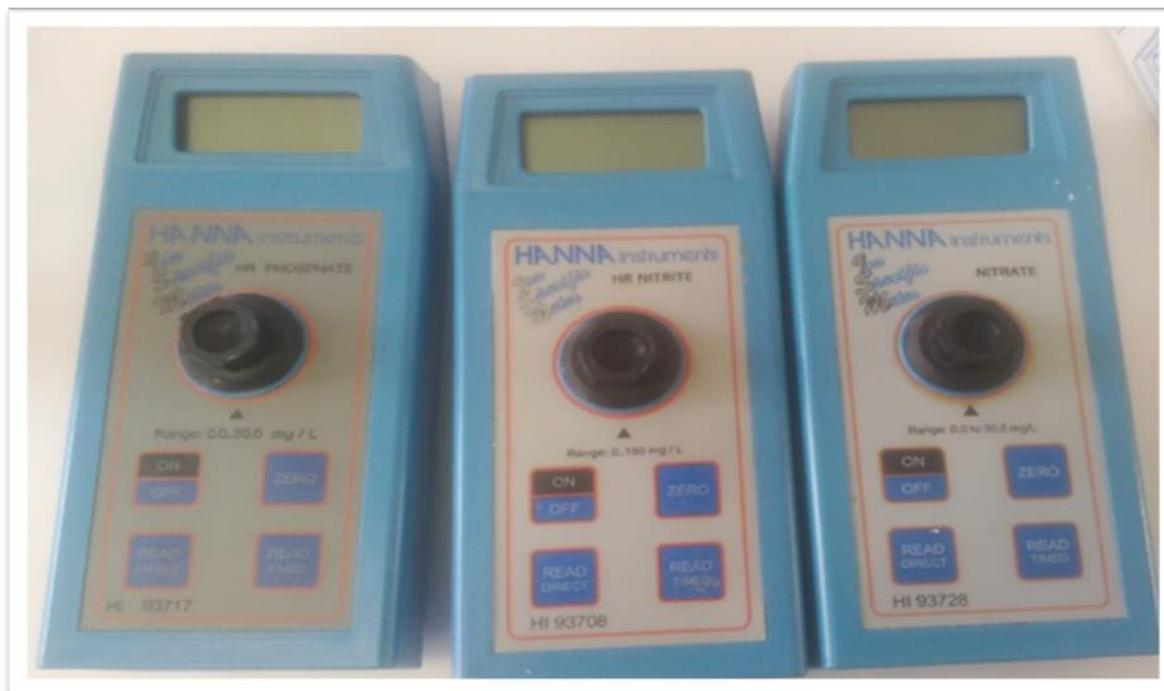
Anexo 2. Instrumentos utilizados para análise de nutrientes-Espectrofotômetros manuais
